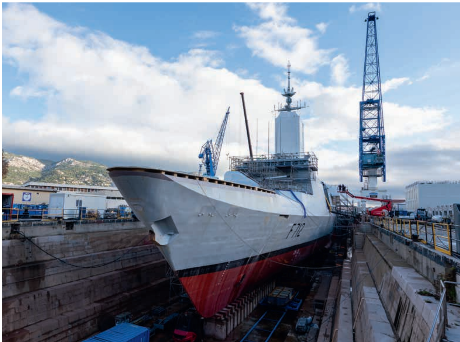
La FLF Courbet installée sur sa ligne de fins dans le bassin Castigneau de la base navale de Toulon.
